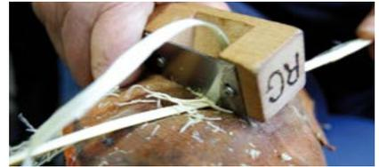
... avant de songer au galet fixé sur une lame d'acier souple qui avale parfaitement les irrégularités des éclisses.
